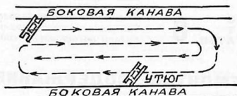
Рис. 4. Последовательность проходов утюга
